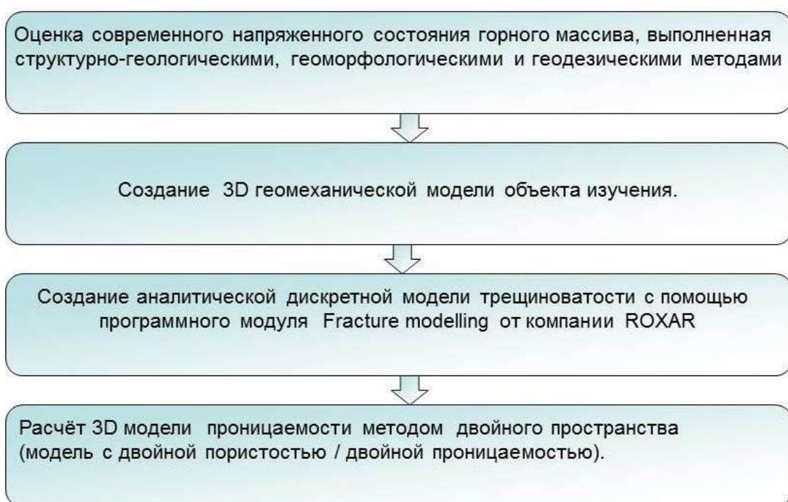
Рисунок 3.1. Технология оценки вторичной флюидной проницаемости горных пород
