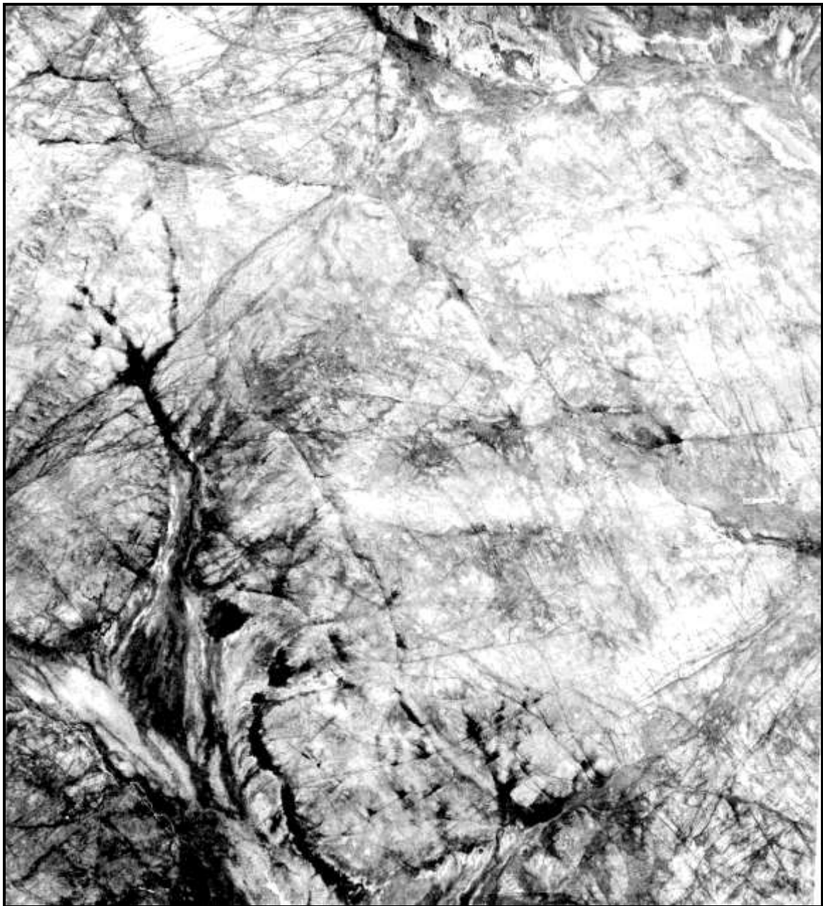
Рис.118. Аэроснимок района Казахстана. Гранитные интрузии, нарушенные системами трещин и разрывов, слагают денудационную равнину.
