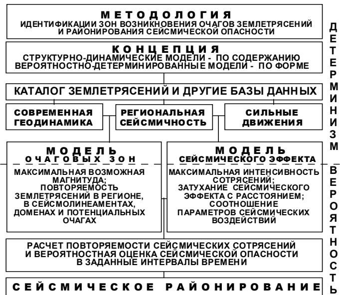
Рис. 2. Блок-диаграмма методологии сейсмического районирования [39, 46]. На основе трех блоков банка данных (геодинамика, сейсмичность и сильные движения грунта) формируются две модели – очаговых зон (МОЗ) и сейсмического эффекта (МСЭ), на основе которых ведется расчет сейсмической опасности и составляются карты сейсмического районирования.
